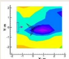
Gráfico de distribución de aire de un HVAC con ventilador apagado
